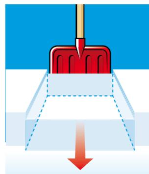
Il test della pala consiste nell'isolare su 3 lati un pilastro di neve e nell'applicare una forza di trazione, su ogni singolo strato, inserendo la lama della pala dietro la colonna e tirando in direzione del pendio fino a causarne la rottura. Lo sforzo necessario a provocare il distacco è proporzionale alla resistenza al taglio dello strato. Questa prova, di rapida e semplice esecuzione, permette di individuare gli strati deboli e stimare il grado di adesione tra i diversi strati.
