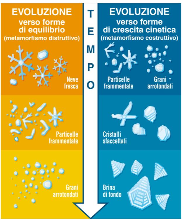
costruzione di cristalli sfaccettati, o a calice, negli strati basali ed intermedi (**metamorfismo costruttivo**). In superficie, invece, con questa temperatura abbiamo la cristallizzazione dell'umidità dell'aria e la formazione di brina;
