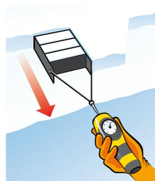
È più specialistico degli altri descritti, ma consente di misurare in modo estremamente preciso la resistenza al taglio degli strati deboli individuati con le altre prove. Si effettua con un telaio da taglio e un dinamometro; viene eseguito quasi esclusivamente per scopi scientifici in quanto richiede una laboriosa esecuzione e complessi calcoli.
